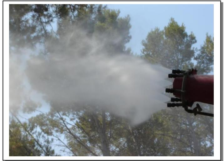
23.6 Detalle del caldo saliendo por las boquillas
