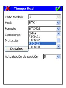
• Pulsar el botón **Detalles** de esta misma pantalla para configurar los parámetros tanto del proveedor del servicio GPRS como del servidor NTRIP.
