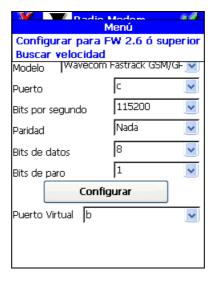
Es necesario configurar el módem para que el GPS pueda gestionarlo correctamente. Para ello se debe utilizar la opción **Configurar para FW 2.6 o superior** del menú de la barra de título. Dicha configuración queda grabada en el módem y, por tanto sólo habrá que hacerlo una vez.
