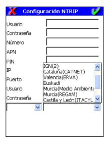
Una vez seleccionado el proveedor de telefonía y el servidor NTRIP sólo será necesario rellenar los campos **PIN** y **Usuario** y **Contraseña** del servidor (situados a continuación del campo **Puerto**).
