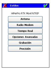
Pulsar el botón Radio Modem y seleccionar los parámetros que se muestran a continuación según los modelos de módem y GPS seleccionados.
